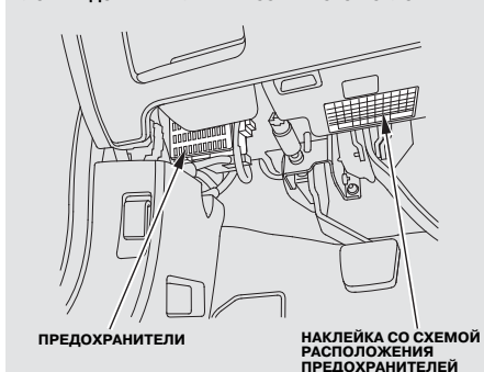
БЛОК ПРЕДОХРАНИТЕЛЕЙ В ПАССАЖИРСКОМ САЛОНЕ
