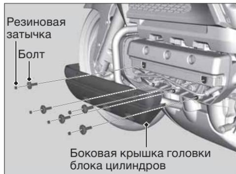
Чтобы провести техническое обслуживание свечей зажигания и сапуна картера, нужно снять левую боковую крышку головки блока цилиндров.
