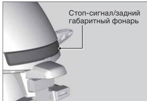
Функцию стоп-сигнала и заднего габаритного фонаря выполняет комбинированный фонарь на светодиодных элементах. Для замены светодиодных ламп обратитесь к официальному дилеру Honda.
