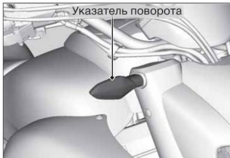
Функцию передних и задних указателей поворота выполняют комбинированные фонари на светодиодных элементах. Для замены светодиодных ламп обратитесь к официальному дилеру Honda.
