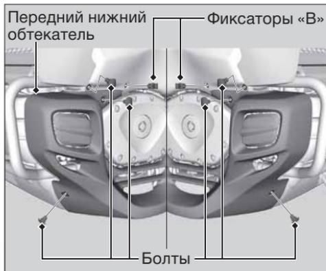
Чтобы проверить уровень моторного масла и провести техническое обслуживание масляного фильтра, нужно снять передний нижний обтекатель.
