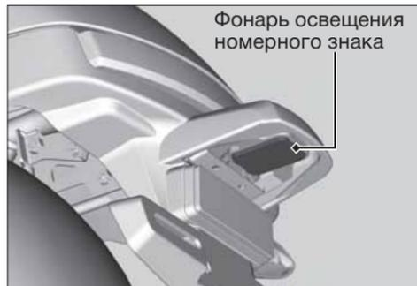
Функцию освещения номерного знака выполняет комбинированный фонарь на светодиодных элементах. Для замены светодиодных ламп обратитесь к официальному дилеру Honda.
