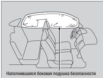
Наполнившаяся боковая подушка безопасности
