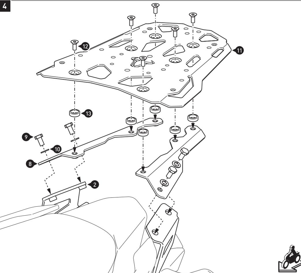
Verschrauben Sie das STEEL-RACK (11) mit den Anbaublechen (8) auf den Rohrstreben (2), wie in der Zeichnung gezeigt.
