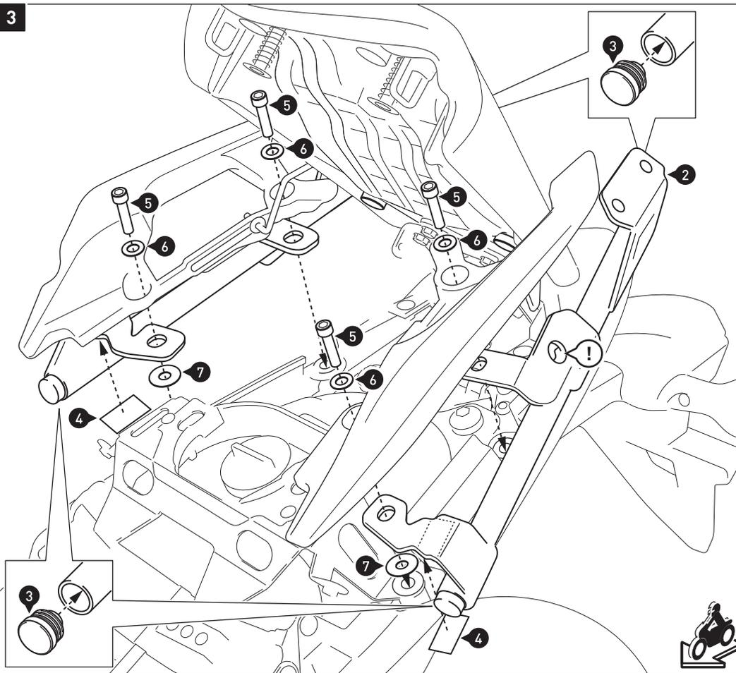
Setzen Sie die Kunststoffstopfen (3) in die Endöffnungen der Rohrstreben (2) ein (siehe Detailzeichnungen).
