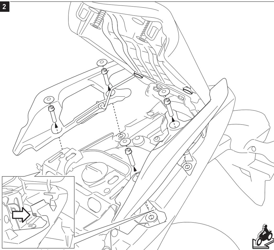
Entfernen Sie die Kunststoffabdeckungen und die originalen Schrauben der Sozius-Haltegriffe. Entfernen Sie anschließend vorsichtig die Soziushaltegriffe vom Fahrzeug.
