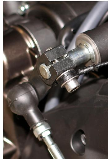
8. **Аккуратно проложите провод датчика к QSE, затем подключите его к 2х контактному разъему.**
