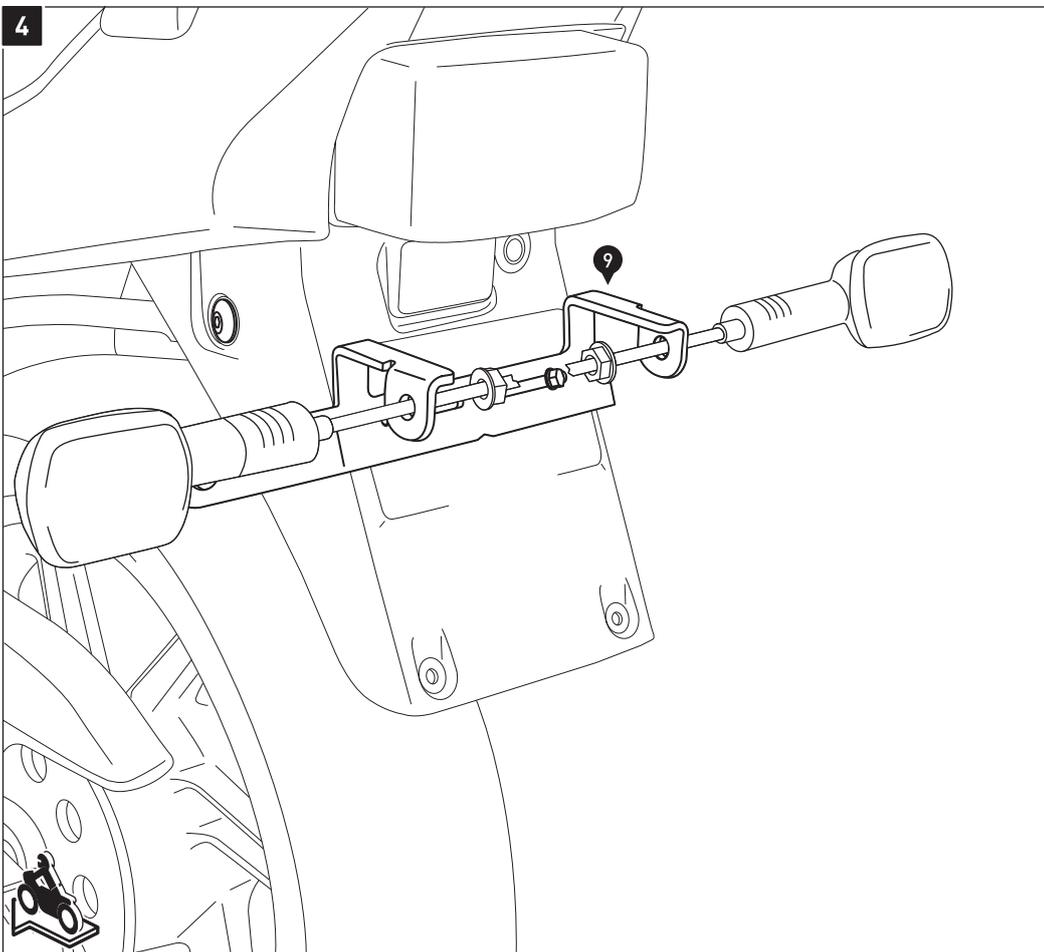
Verbauen Sie die in Schritt 1 entfernten Blinker am Querverbinder (9), wie in der Zeichnung gezeigt. Verlegen Sie die Kabel entlang des Rücklichtes.
