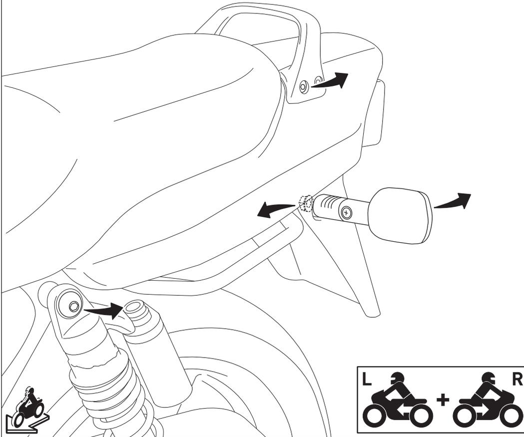
Lösen Sie die markierten Schrauben und Muttern, entfernen Sie diese mit dem Blinker vom Fahrzeug.
