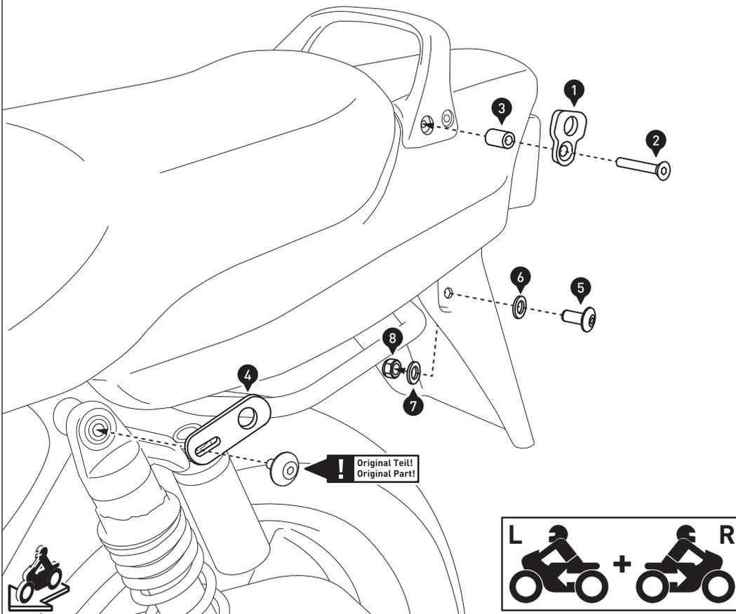
Verschrauben Sie die Befestigungslaschen (1) und (4) am Fahrzeug, wie in der Zeichnung gezeigt. Verschließen Sie die original Anbaupunkte der Blinker, wie in der Zeichnung dargestellt.
