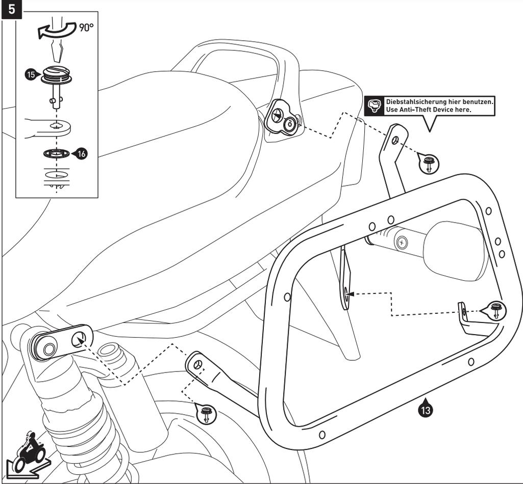
Verbinden Sie die Koffertträger (13) und (14) an den Befestigungs- laschen und dem Querverbinder (9) mit den Schnellverschlüssen (15). Sichern Sie die Schnellverschlüsse (15) mit den Sicherungsscheiben (16).
